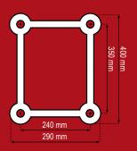
Breite: 290 mm 400 mm Höhe: 50 x 3 mm Tragrohr: Füllstäbe: 25 x 3 mm EN-AW 6082 T6 Legierung
